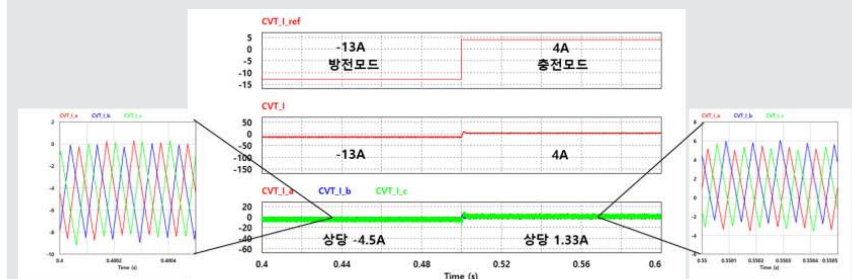
Fig 5. 벅 및 부스트 모드 동작 시뮬레이션 결과
