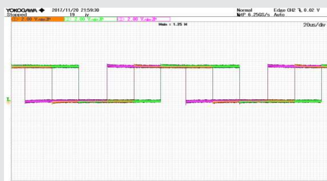
Fig 3. 인터리브드를 위한 PWM 위상차와 Dead Time을 고려한 PWM 파형
